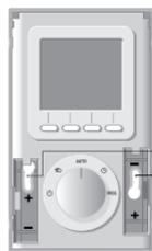
Befestigen Sie die Zentralsteuerung mit Schrauben und Dübeln an der Wand bzw. verwenden Sie eine Unterputzdose (1), Achsabstand 60 mm).
