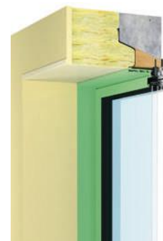
Isolation thermique par l'extérieur (ITE)
