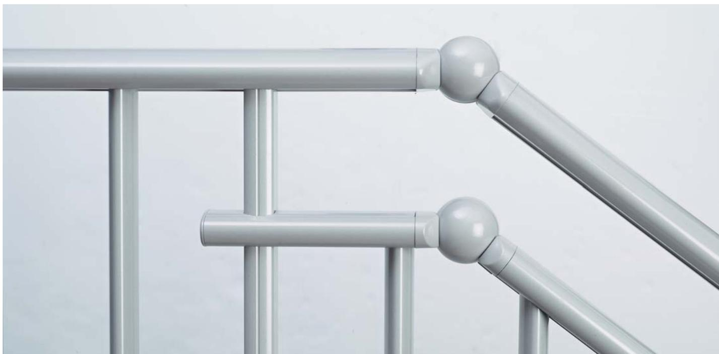
Les garde-corps et rampes d'accès Chardonnay pour escalier sont constitués de profils en alliage d'aluminium extrudés tels que potelets, lisses et barreudages. Fixation des poteaux sur dalle par sabots. Main courante de forme elliptique avec possibilité de liserés de couleur sur barreudage.
