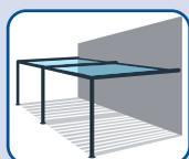
Pose murale avec deux fixations au sol et deux au mur avec ou sans poutre contre la façade. Lames parallèles ou perpendiculaires à la façade.
