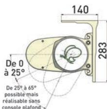
Fixation plafond avec équerres sup. réglable de 0 à 25°
