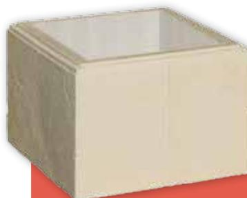
Une feuille de matériau compressible habille l'intérieur des éléments de pilier et des chapiteaux Tradition afin d'éviter tout risque de fissuration. Ce revêtement souple absorbe les différences de dilatation entre le béton de remplissage et l'élément en pierre reconstituée.
