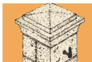
6. Sceller le chapeau sur le chapiteau par un joint de mastic-colle. Il est impératif de réaliser toute fixation dans le pilier par scellement chimique, sans serrage contre la paroi du pilier (utiliser des gonds à scellement réglables). Pour le perçage, ne pas employer de perforateur.
