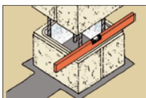
3. Après séchage de la fondation, poser et mettre de niveau le 1<sup>er</sup> élément de pilier, emboîtement mâle vers le haut (sauf Chambord qui ne possède pas d'emboîtement). L'assemblage se fait par superposition des éléments. Pour éviter toutes fuites de laitance, on peut appliquer un joint à la pompe sur le pourtour de l'emboîtement.
