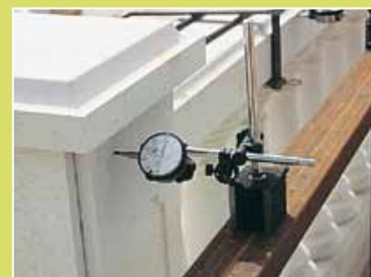
Lorsque la balustrade joue le rôle de garde-corps, elle doit présenter une résistance définie par la norme NF P 01-013 «Essais des garde-corps».
